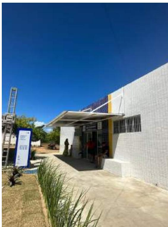
Imagen: Fachada frontal da UBS Carapibus – Marquise metálica, revestimento cerâmico nas fachadas
